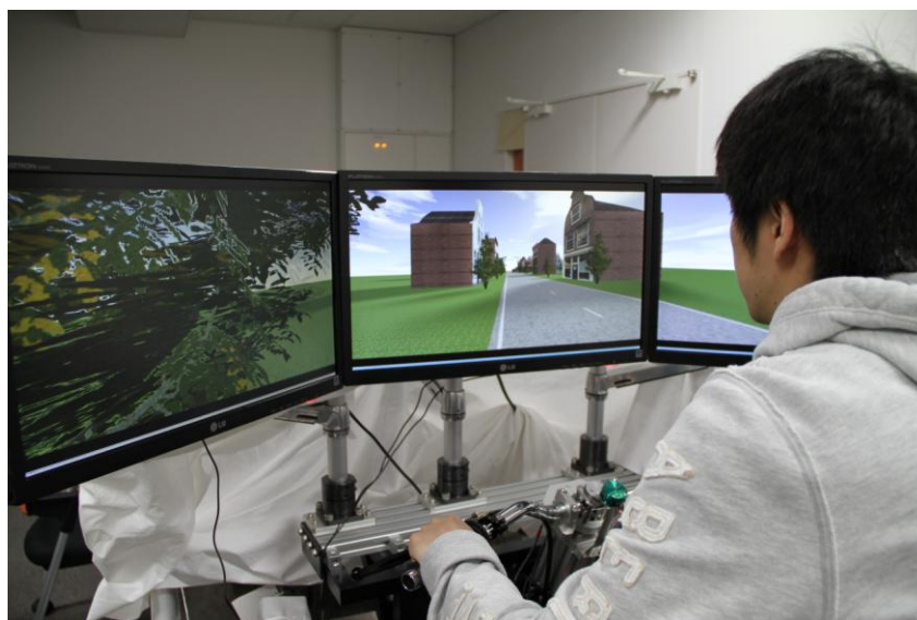
写真 1 バイクシミュレータで操縦するライダー
