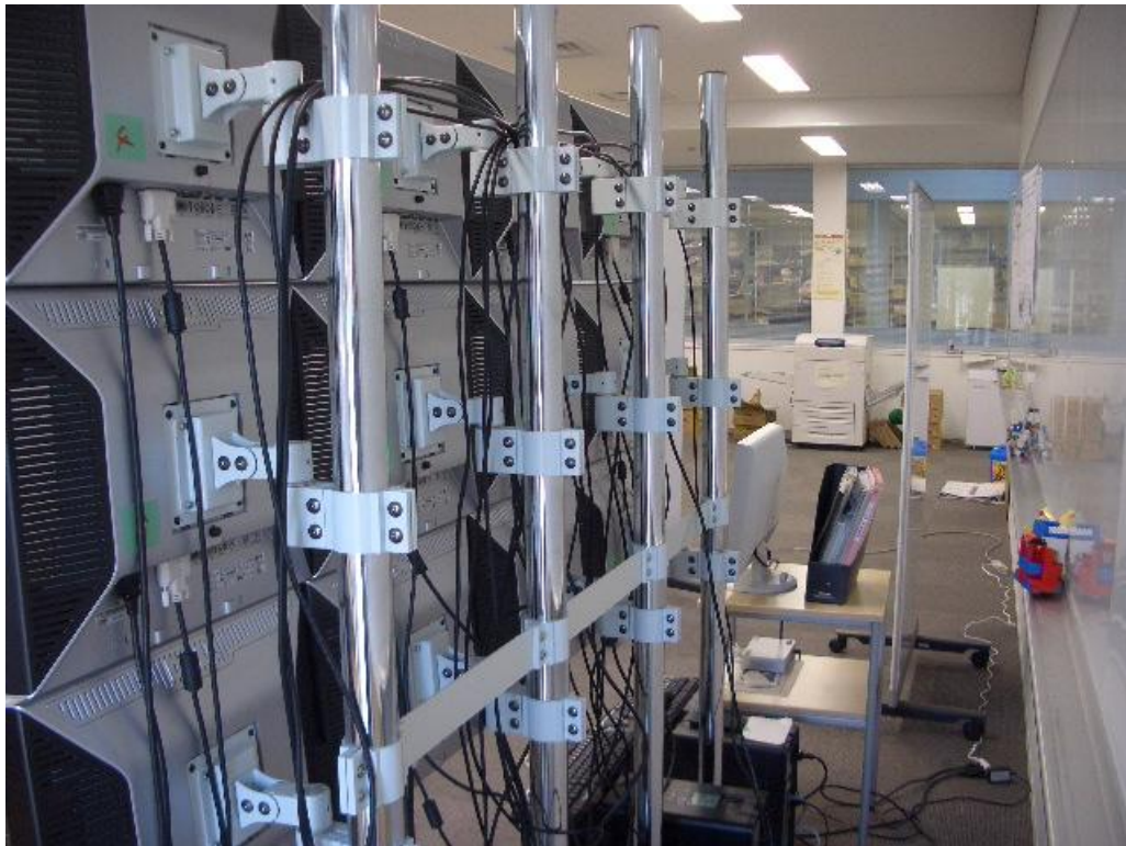
図 15: 構築したタイルドディスプレイ(裏)
