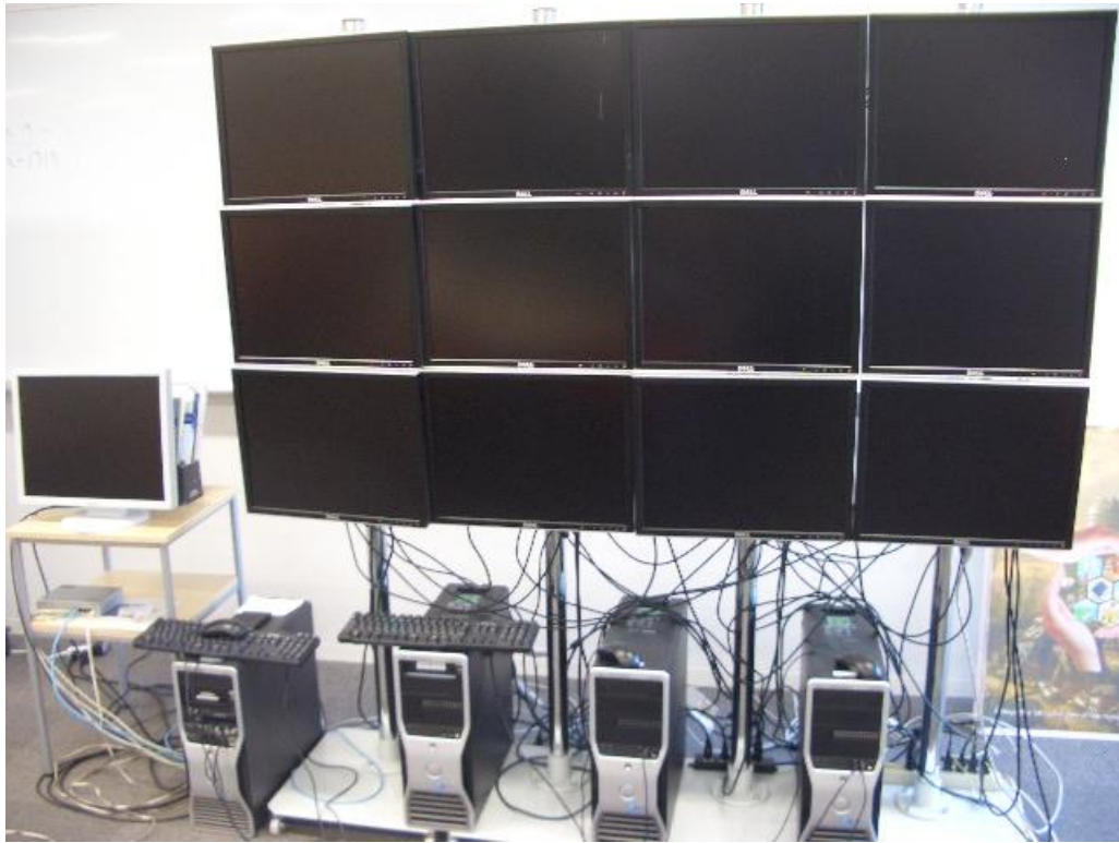
図 14: 構築したタイルドディスプレイ(表)
