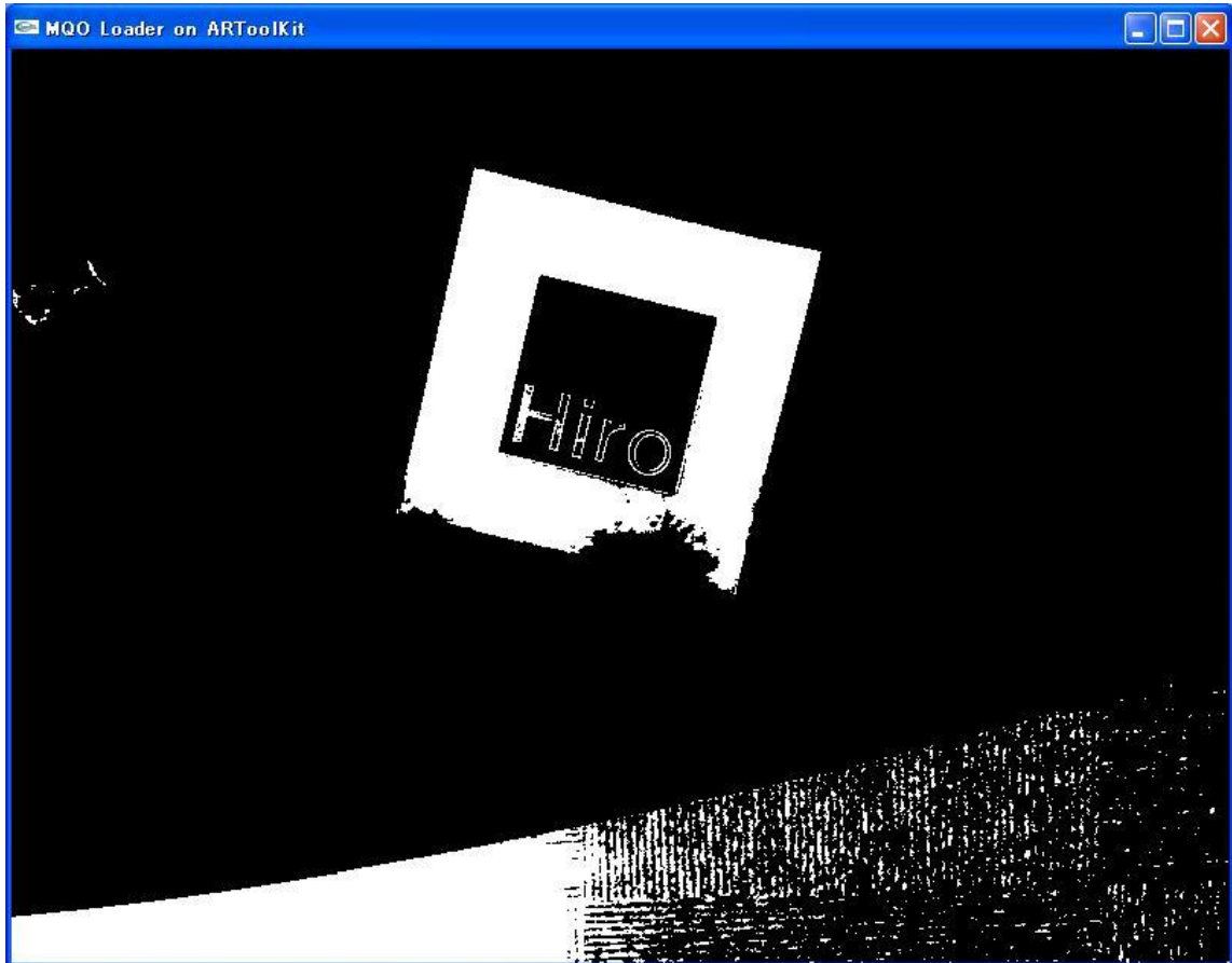
図 40 マーカ認識失敗時の画像処理
