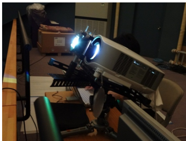
図 3-4 : NP2000J, DCR-CF185PRO, 三脚を組み合わせたプロジェクター
