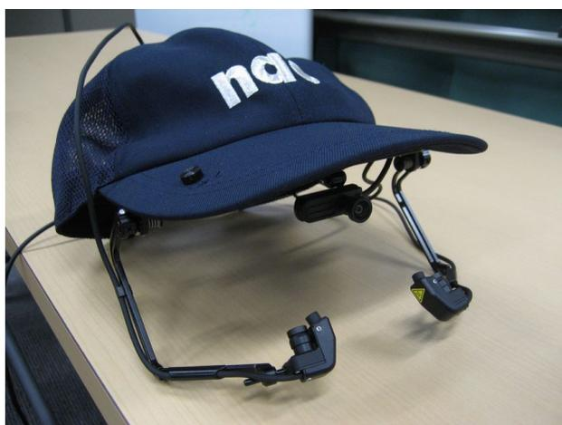
Fig. 3.5 視線計測装置 EMR-9
