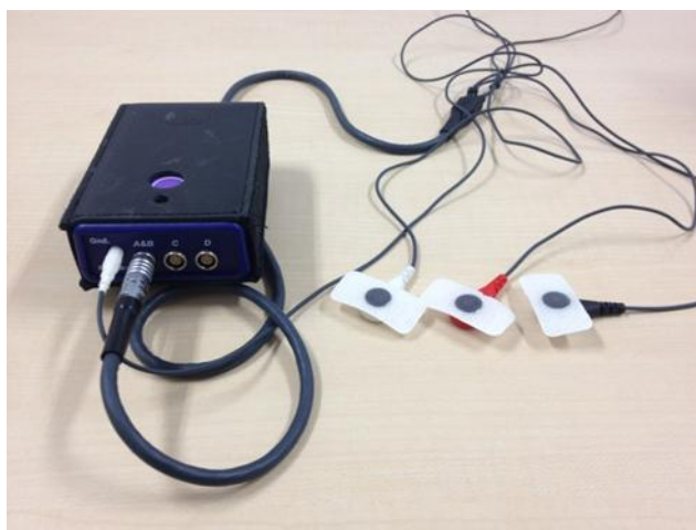
図 23 BioTrace+for NeXus-4 とディスプレイサブル心電図電極
