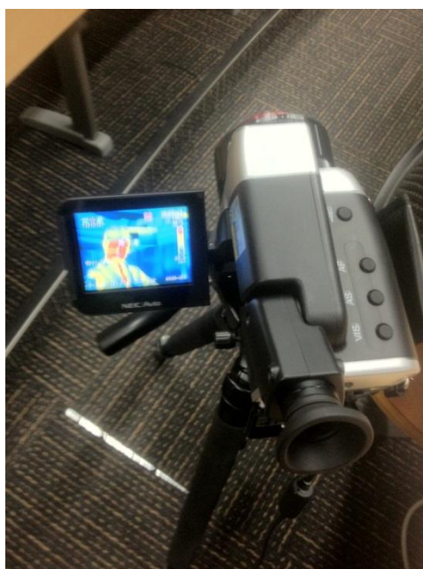
図 27 サーモカメラ (NEC/Avio InfReC Thermography R300S)
