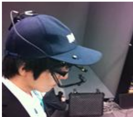
図 33 視点計測機ナックアイマークレコーダ (EMR-9) を装着
