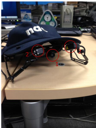
図 34 視点計測機 (EMR-9) のカメラ
