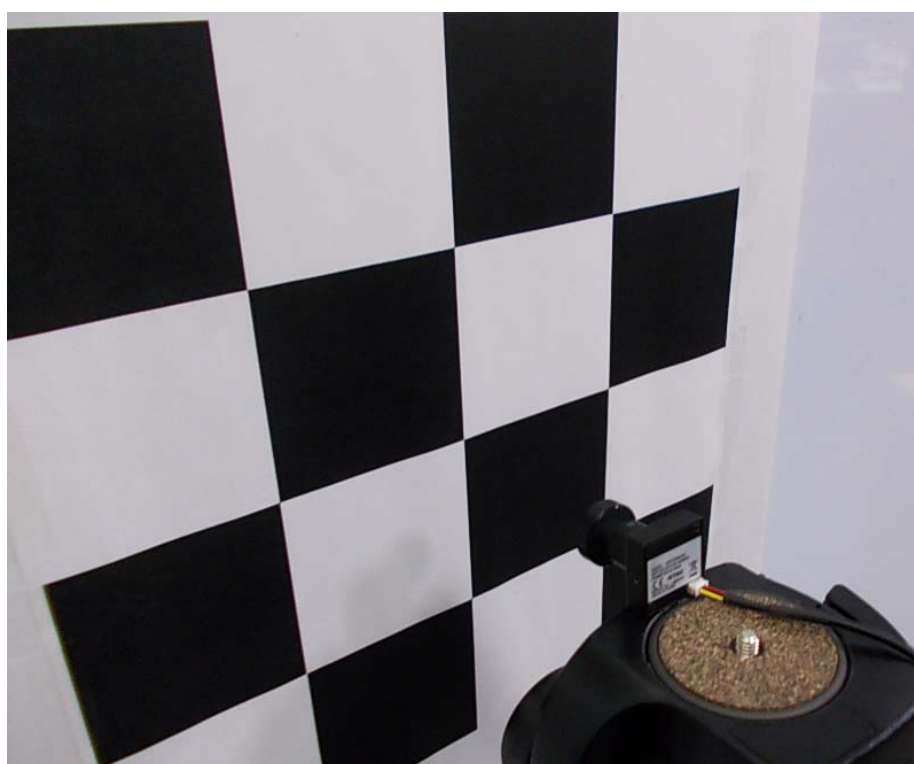
図33：カメラキャリブレーションのための撮影を行う様子
