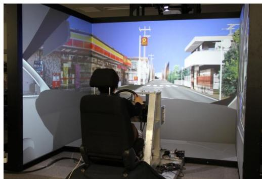
没入型ドライビングシミュレータの外観
