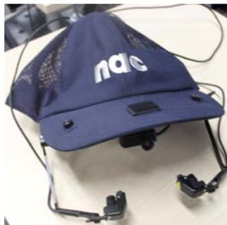
Fig. 5 The eye mark recorder EMR-9.
