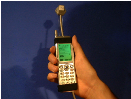
図1 携帯電話を用いた入力デバイス Fig. 1 Input device using cellular phone
