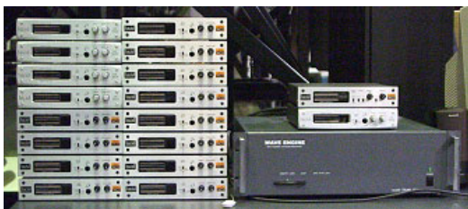
図2 マルチチャンネル畳み込み演算装置WAVE ENGINE Fig.2 Multi-channel Digital Signal Processor: WAVE ENGINE
