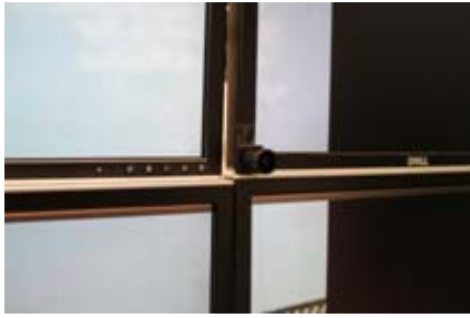
図 1: タイルディスプレイの枠に取り付けた魚眼カメラ
