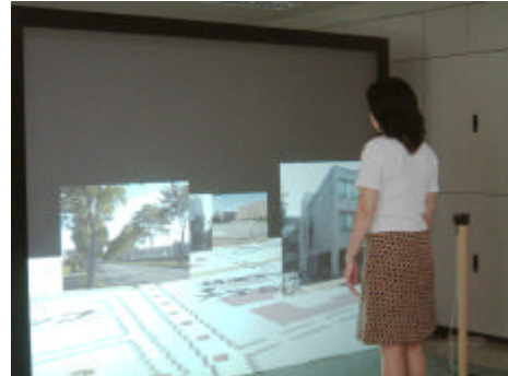
図2 フィールド画像で構成された没入仮想空間 Fig.2 Immersive Virtual World Constructed from the Images Captured in the Real Field
