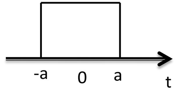
$$= \frac{e^{j\omega a} - e^{-j\omega a}}{j\omega} = 2a \frac{\sin(a\omega)}{a\omega}$$
